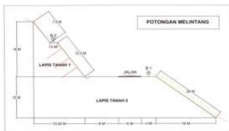
Gambar 13. Potongan Melintang Lokasi Tinjauan dengan sistem soil nailing dan anchor (Sumber: Hasil Penelitian)
