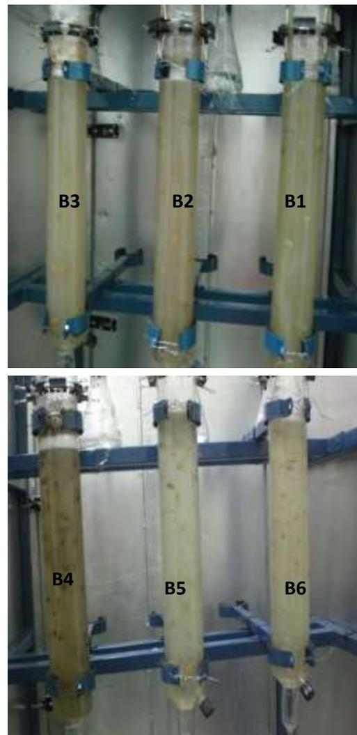
Gambar 2. Penampakan kultur sel dalam bioreaktor pada variasi inokulum dan aerasi
