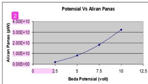
Gambar 6. Aliran panas dengan variasi beda potensial
