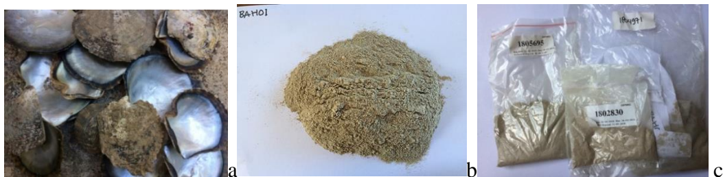
Gambar 2. (a) Limbah cangkang P. margaritifera (b) Tepung cangkang (c) sampel untuk di uji
