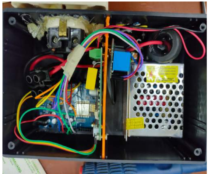
Gambar 13 Wiring komponen Smart meter
