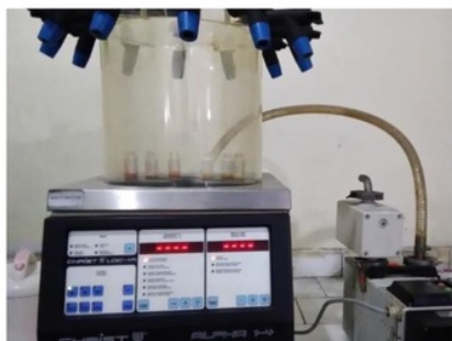
Gambar 4. Proses pengeringan ke-enam fraksi ODS spons Agelas sp. dengan alat freeze-dryer (Dokumentasi pribadi, 2017).
