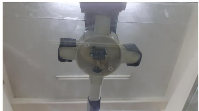
Gambar 3 Sensor VL53L0X yang di pasang di Akuarium Simulasi
