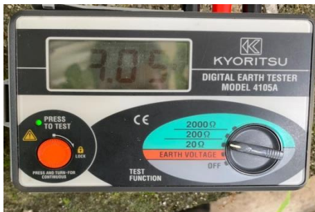
Gambar 14. Hasil Pengukuran Dengan Earth Tester Kyoritsu
