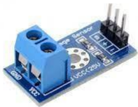
Gambar 2. Sensor Tegangan (Sumber: Octavian 2019)
