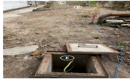
Gambar 15. Jarak Antar Elektroda 6 Meter
