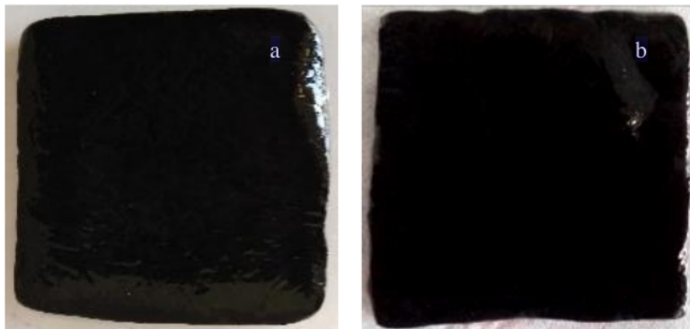
Gambar 2. Perubahan warna nata de coco setelah penambahan reduktor dan sonikasi dalam larutan prekursor: (a) K_2PtCl_4 10 mM dan (b) K_2PtCl_4 20 mM.
