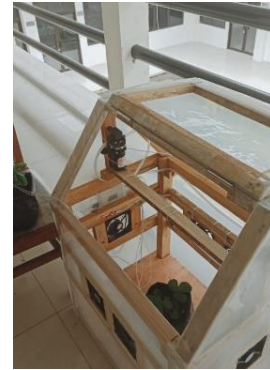
Gambar 33 Pengujian Pompa Air DC
