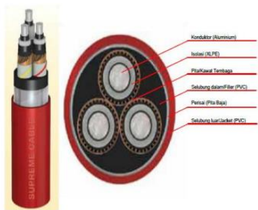
Gambar 4. Penampang Kabel SKTM
