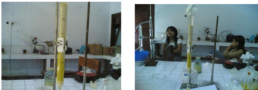
Gambar 2. Proses pemisahan metil laurat dengan kromatografi kolom
