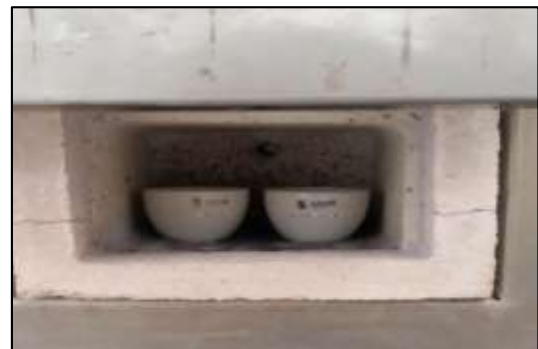
Proses pembakaran dengan tanur pada suhu 600°C
