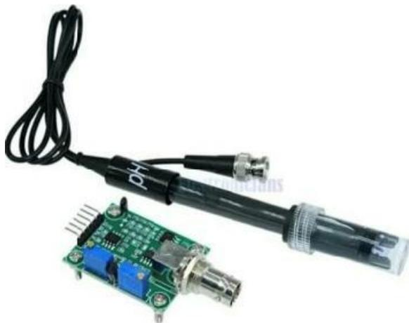
Gambar 3. Sensor PH Meter
