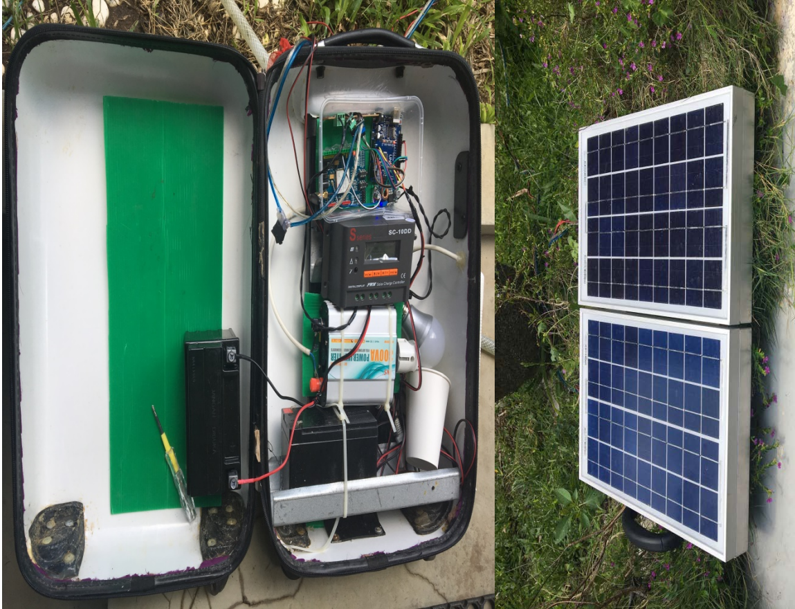
Gambar 3. Model prototype portable solar luggage dengan sistem monitoring
