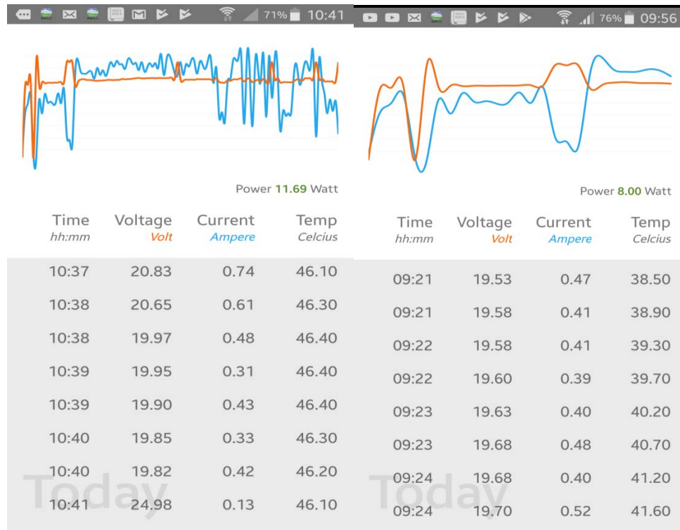
Gambar 16. Cuplikan layar hasil pencatatan data monitoring arus, tegangan dan suhu panel surya
