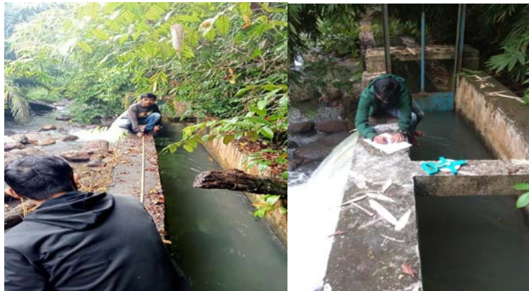
Gambar 2. Pengukuran debit dan tinggi jatuh air sungai Tulaun yang berpotensi untuk lokasi PLTMH
