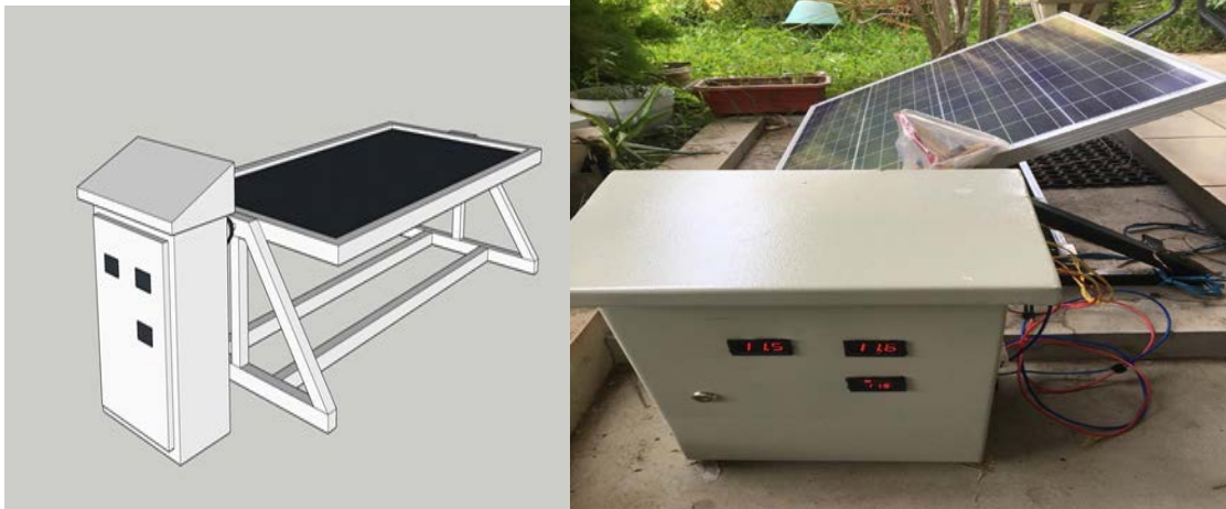
Gambar 8. Desain dan Purwarupa Solar Tracking sebagai Luaran Riset
