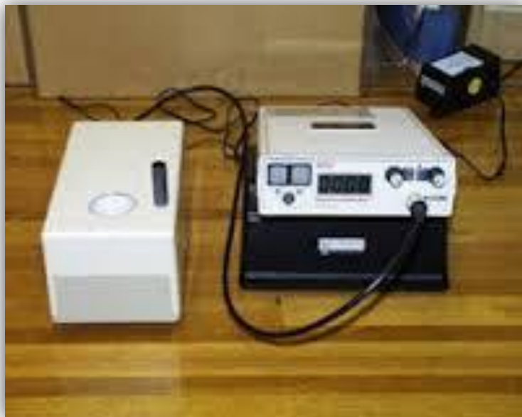
Gambar L6. Alat-alat ukur magnetik yang digunakan (a) Demagnetizer, (b) Minispin Magnetometer, (c) Suseptibilitas Meter
