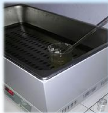
Gelatin dilarutkan dengan aquades + plasticizer gliserol ( 10% ), di homogenisasi dalam waterbath (suhu 50°C)
