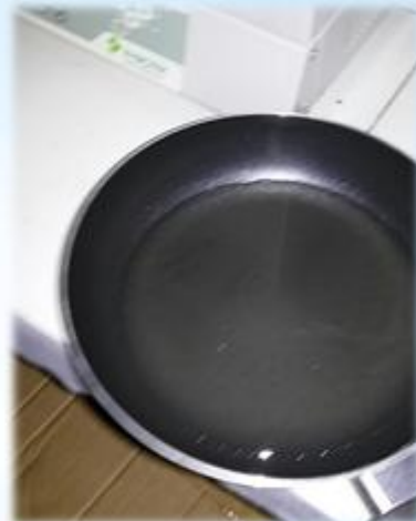
Setelah dikeringkan, diangin-anginkan pada suhu kamar (10 menit), dilepaskan edible film perlahan-lahan dari teflon.
