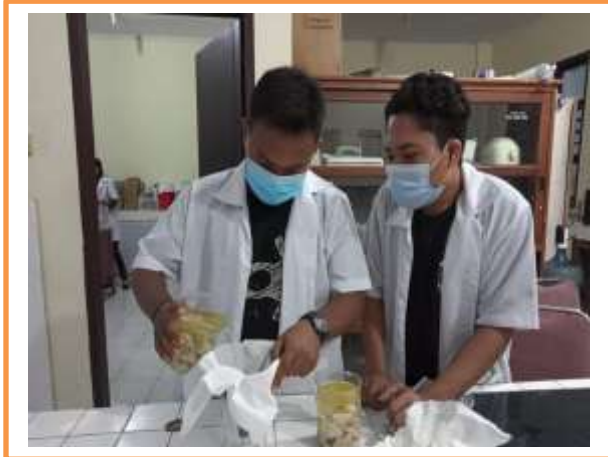
Penyaringan larutan tulang sapi sehingga mendapatkan filtrate gelatin
