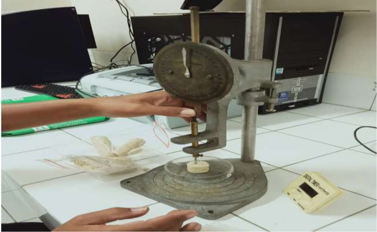
Uji Keempukan Sosis Sapi di Lab Teknologi Daging Fapet UGM
