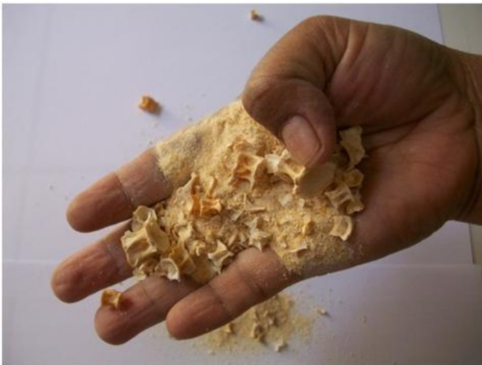
Gambar 7.3 Tulang Ikan Produk Hidrolisis NaOH (4 persen; 48 jam), Secara Fisik Mudah Dihancurkan.
