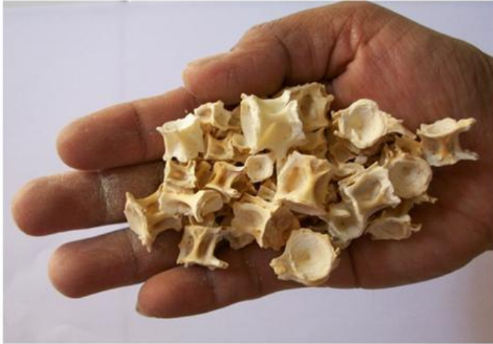
Gambar 7.2 Tulang Ikan Produk Hidrolisis NaOH (4 persen; 48 jam).
