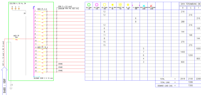
Gambar 4.3 Wiring Panel Pembagi Lantai 1 A
