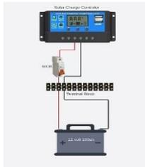
Gambar. 12 Rangkaian Baterai dan Solar Charge Controller
