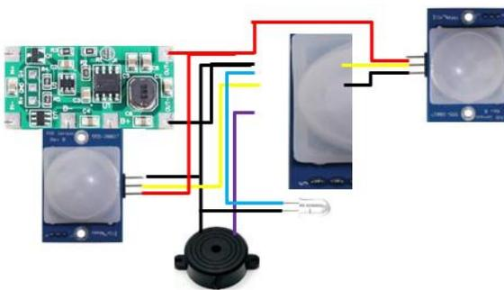
Gambar 2. Rangkaian Keseluruhan Sistem Keamanan
